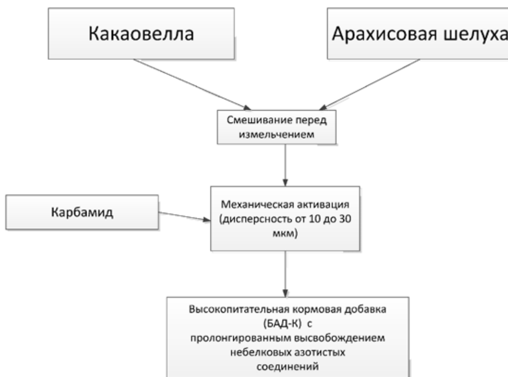
Рис. 3. Схема получения высокопитательной кормовой добавки БАД-К с пролонгированным высвобождением небелковых азотистых соединений
