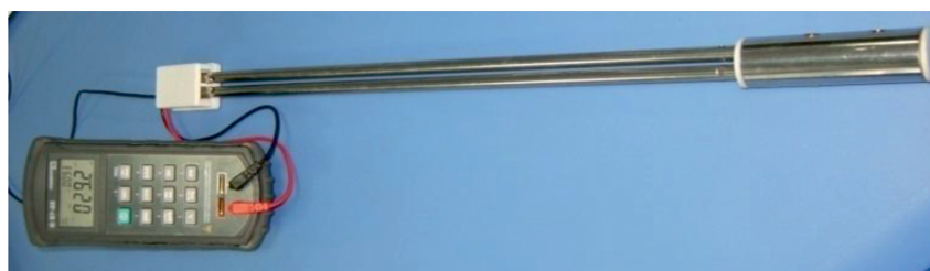
Рис. 4. Измеритель уровня и диэлектрических свойств жидкости
